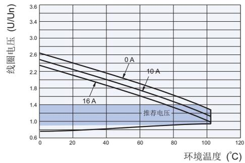
备注：\* 继电器使用过程中，如果激励电压超过额定电压将会导致继电器电耐久性降低。在推荐电压范围内，对电耐久性的影响会小一些。超过图中曲线规定的上限值，继电器线圈的绝缘有可能会被损坏。
